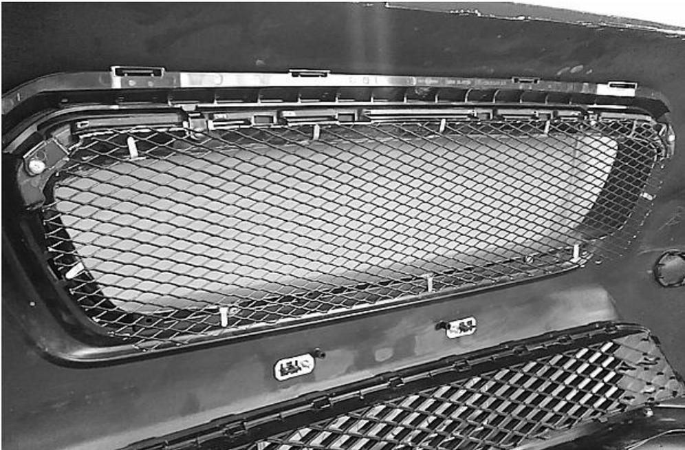
取付けが完了しましたらボルトの締め忘れが無いか最終確認を行って下さい。
