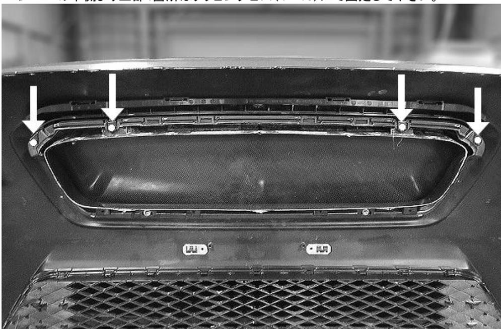
下部はタッピングビスにワッシャーを使用して、2箇所固定して下さい。
