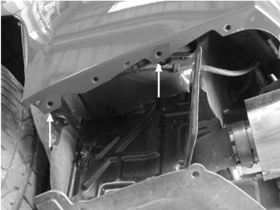
サイド下部は純正のクリップにてリアディフューザーをアンダーカバーに左右3箇所ずつ、計6箇所、固定します。
