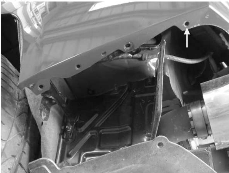
付属のボルトナット(6×20)にてリアディフューザーをバンパー下部に左右2箇所ずつ、計4箇所、固定します。作業はタイヤハウス内からになります。全体のバランスを調節しながら、確実に固定して下さい。
