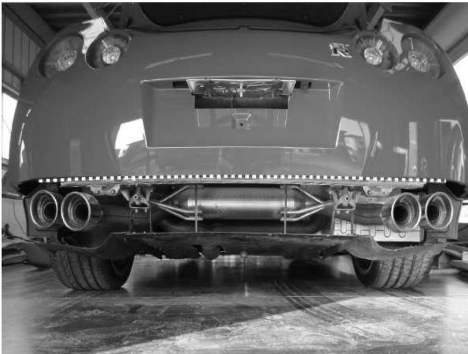
マフラー出口下側よりの純正のクリップにてリアディフューザーをバンパーに左右1箇所ずつ、計2箇所、固定します。
