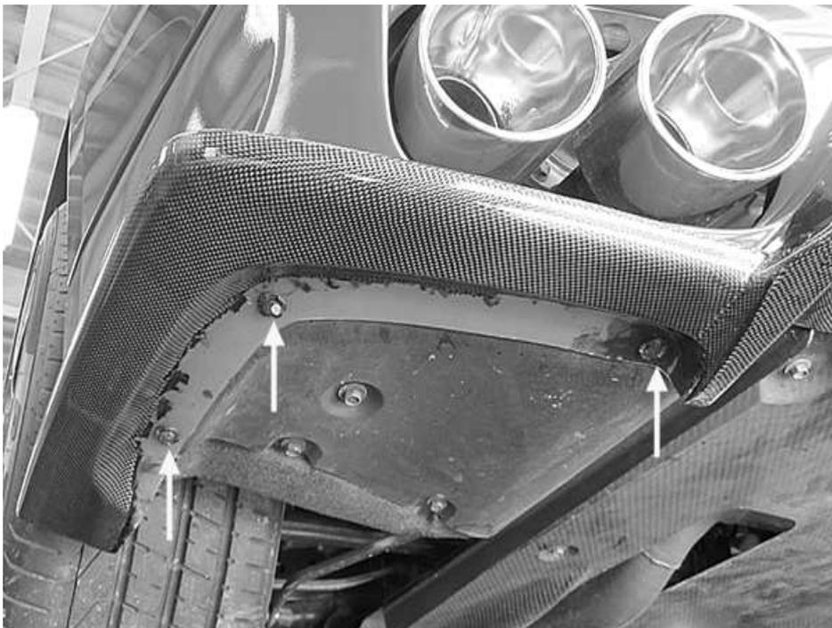
ディフューザーリアーを4箇所純正クリップにて純正アンダーカバーへ固定します。
