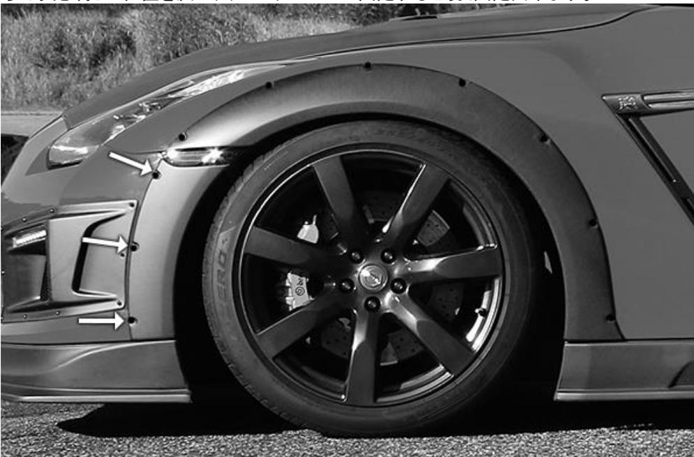
取付けが完了しましたらタッピングビスの締め忘れが無いかな最終確認を行って下さい。
