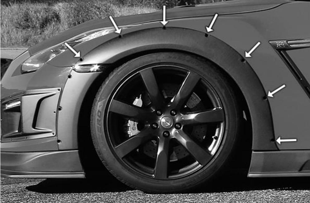
正しい位置にバンパー部のオーバーフェンダーを仮合わせし全体のバランスを見て正しい穴位置に印を付けて下さい。付属のタッピングビス(4×16)にて片側 3箇所、左右 計6箇所固定します。純正バンパーは柔らかい材質で出来ていますのでタッピングビス固定の際に先の尖った工具等を少し突き刺して位置を決めタッピングビスにて固定すると硬く固定出来ます。
