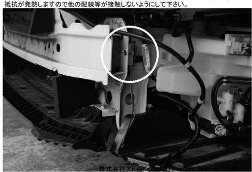
(2)LEDフロントインジケーターランプ後側のコネクタを接続します。 コネクタ(A)に車両側のウインカーのコネクタを接続します。 コネクタ(B)に抵抗からのコネクタを接続します。 右側も同様に接続して下さい。
