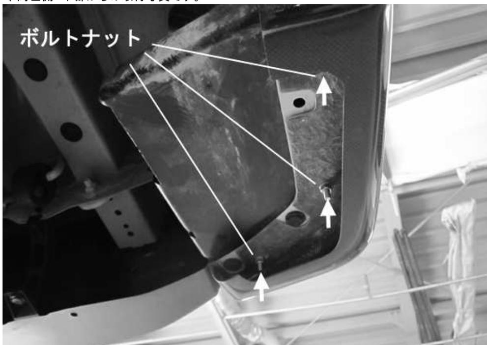
純正リアバンパーの左右にリアボトムラインを装着後、純正リアバンパーを車両に取付けて下さい。
