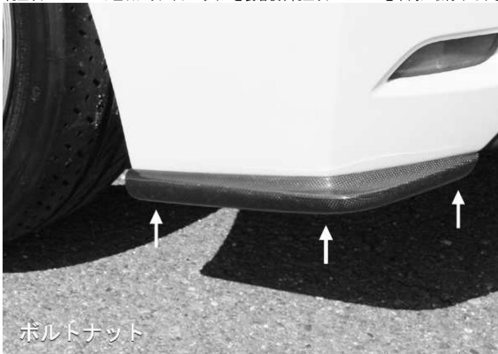
取り付けが完了しましたらボルトの締め忘れが無いか最終確認を行って下さい。
