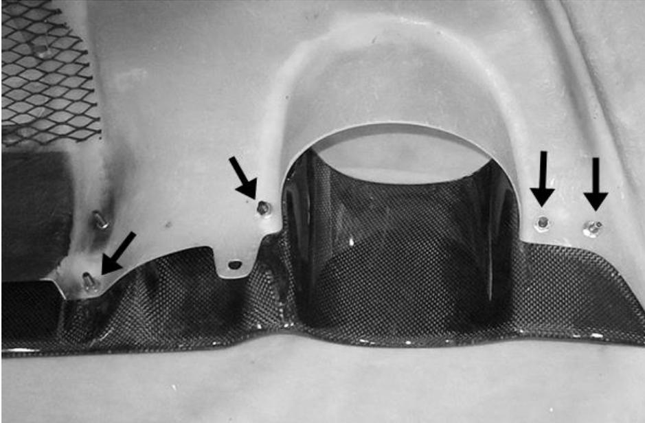
矢印の1箇所は左右とも内側のワッシャーを使用しないでボルトとナットのみで固定して下さい。
