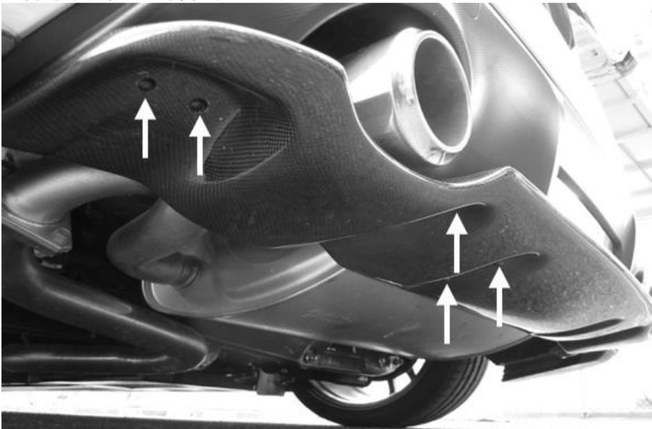
取り付けが完了しましたらボルトの締め忘れが無い最終確認を行って下さい。
