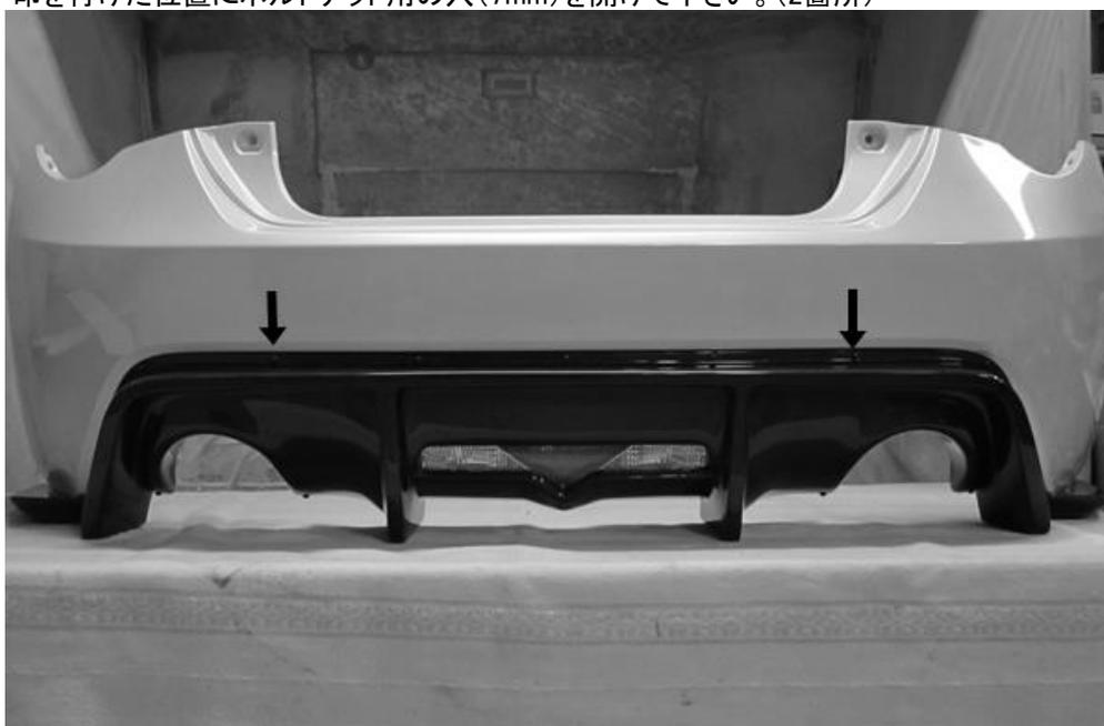
付属のボルトナット(5×20)で純正リアバンパーに固定します。
