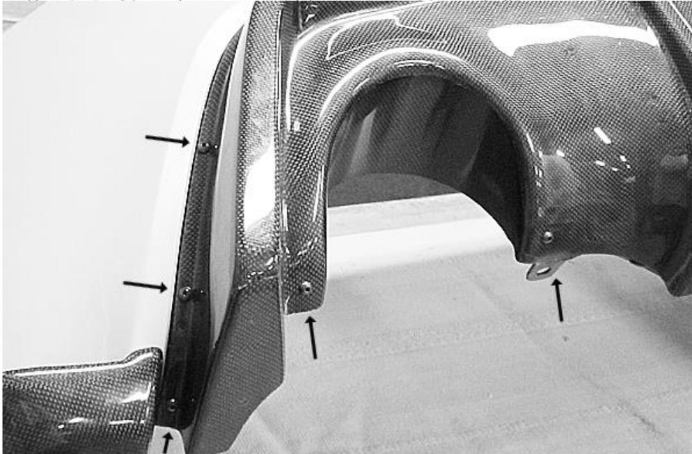
付属のボルトナット(6×12)で純正リアバンパーに固定します。
