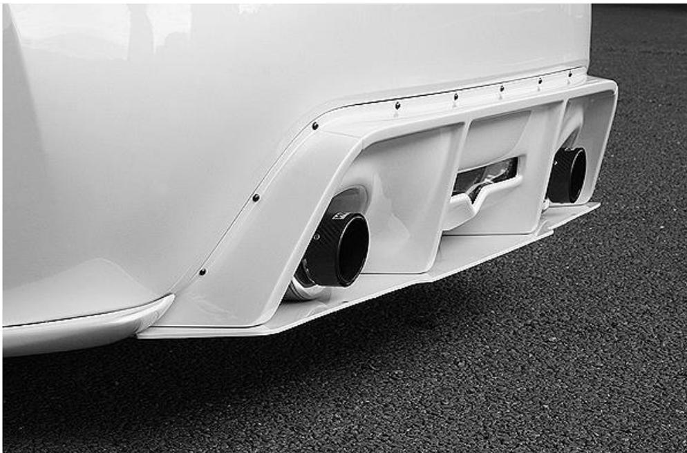
純正リアバンパーにリアディフューザーカウルを装着後、純正リアバンパーを車両に取付けて下さい。
