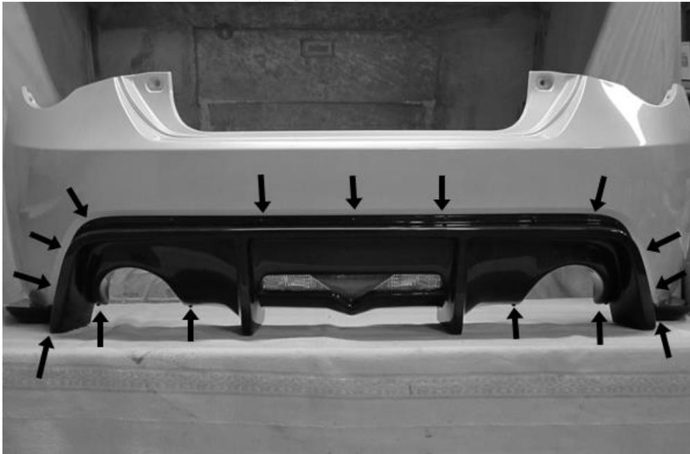
画像は車両左側 下部からの取付写真です、車両右側も同じ要領で取付けを行って下さい。
