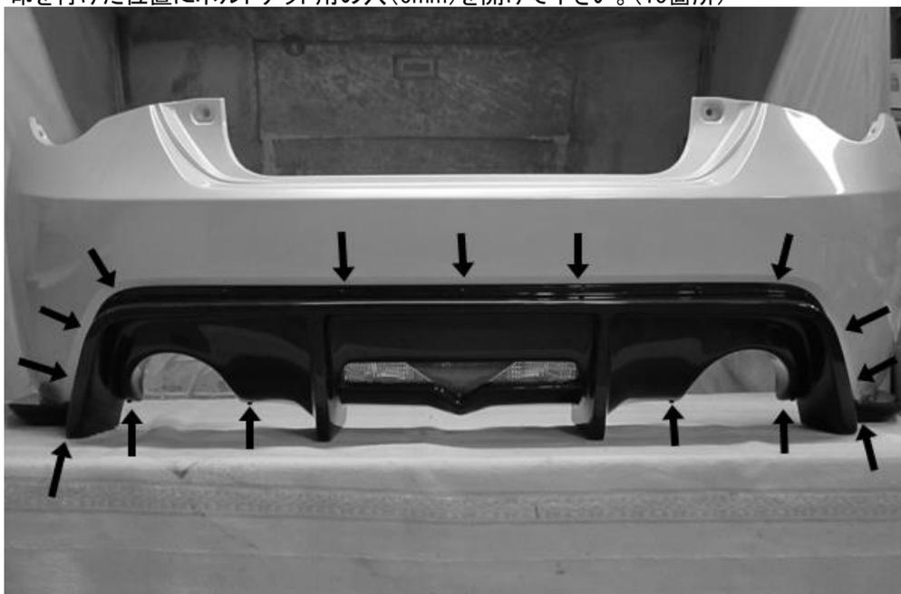
印を付けた位置にボルトナット用の穴(7mm)を開けて下さい。(2箇所)
