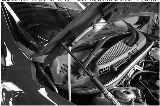
ボンネットダンパーを左右共取外し保管して下さい。 樹脂製のボンネットの為 ボンネットの浮き上がり防止の為に取外します。
