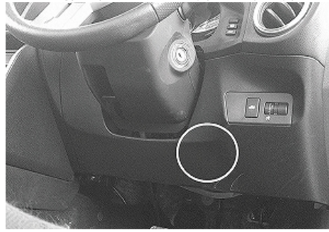
41. D配線のウエルカムランプ線の黒線と、C配線のウエルカムランプ線の黒線を 付属のスプライスを使用し結線します。 D配線のウエルカムランプ線の白線と、C配線のウエルカムランプ線の白線を 付属のスプライスを使用し結線します。 結線部分をビニールテープ等で絶縁します。 (末尾スプライス接続方法参照)
