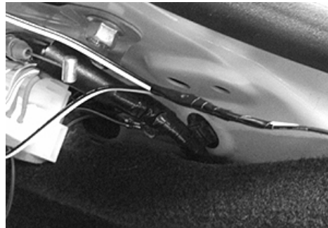
42. ダッシュボードの横側の点線のカバーを外します。
