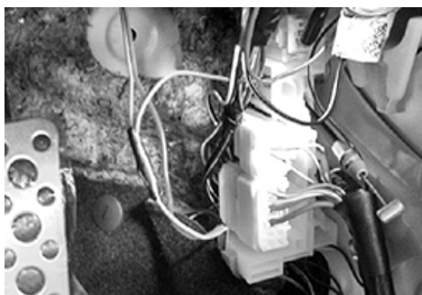
39. B配線のウインカー線の黒線と、A配線のウインカー線の黒線を2本束ねて クワ型端子を使い○印の位置の純正アース線と一緒に固定します。 (末尾クワ型端子接続方法参照)
