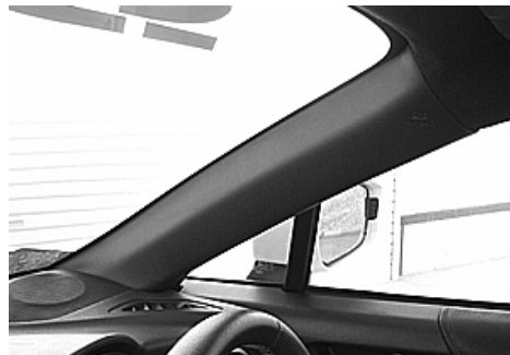
43. Aピラー内側のカバーを外します。カバーの上部を浮かせて引っ張ると外れます。
