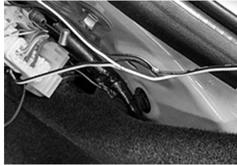
41. D配線のウエルカムランプ線の黒線と、C配線のウエルカムランプ線の黒線を 付属のスプライスを使用し結線します。 D配線のウエルカムランプ線の白線と、C配線のウエルカムランプ線の白線を 付属のスプライスを使用し結線します。 結線部分をビニールテープ等で絶縁します。 (末尾スプライス接続方法参照)
