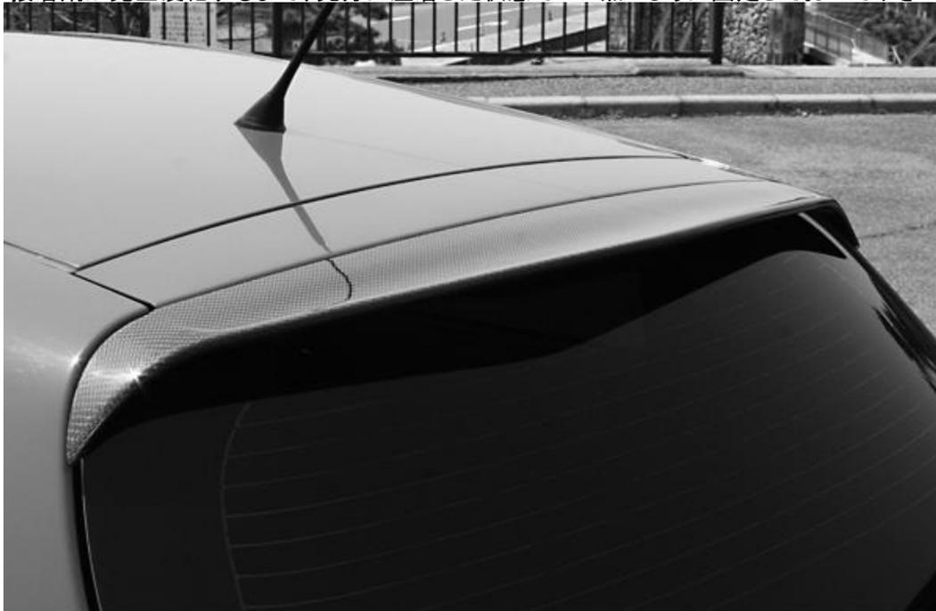
純正のリアワイパーは動作時に、リアスポイラーに干渉しますので、
